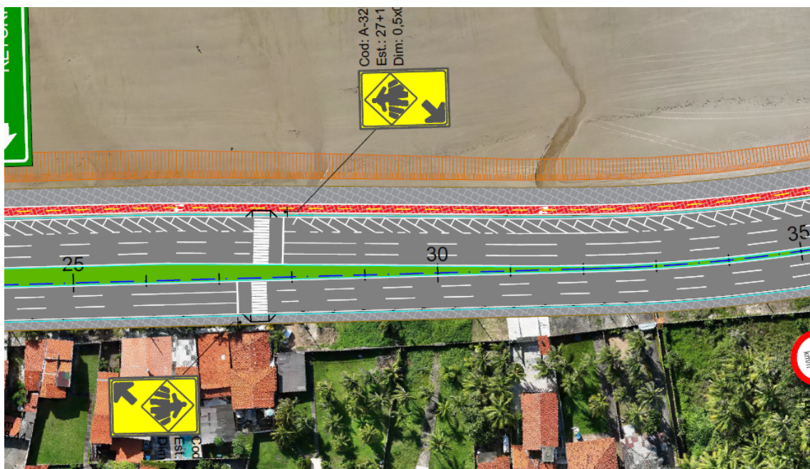
Figura 13 – Trecho entre as estacas 25 e 35 do projeto de sinalização (projeto executivo) sem as placas indicativas de exclusividade de trânsito de ônibus
